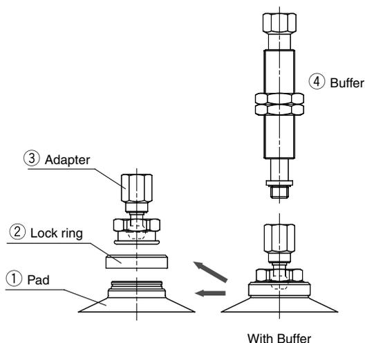
Pad Diameter:  $\varnothing 40$ ,  $\varnothing 50$
