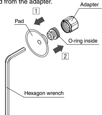
Pad diameter:  $\varnothing 40$ ,  $\varnothing 50$
