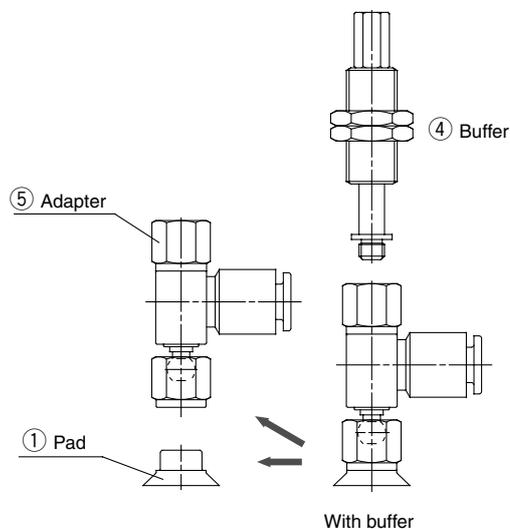
Pad Diameter:  $\varnothing 40$ ,  $\varnothing 50$
